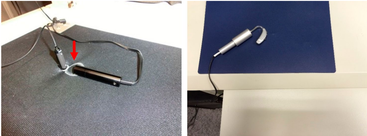
Abb. 8: Bei der geschlossenen Version der Messbox ACAM der Firma Acousticon Hörsysteme wird das Anlagenmikrofon mit Typenreiniger (oder anderer geeigneter Knetmasse) senkrecht nach unten ausgerichtet (siehe linker Teil der Abb.). Im rechten Teil der Abbildung wird die Positionierung des Kupplers mit Hörgerät in ausreichender Entfernung zum Signallautsprecher veranschaulicht.
