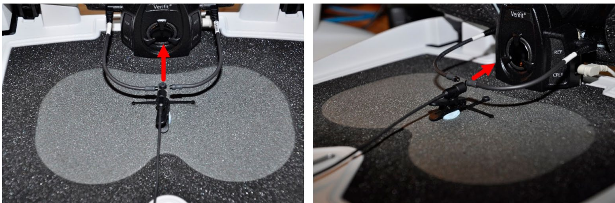
Abb. 13: Bei der Messbox Verifit 2 der Firma AURITEC Medizindiagnostische Systeme wird das Anlagenmikrofon mittig nach vorne hin ausgerichtet. Dies ist aus einer hinteren (links) und seitlichen (rechts) Perspektive in der Abbildung veranschaulicht.
